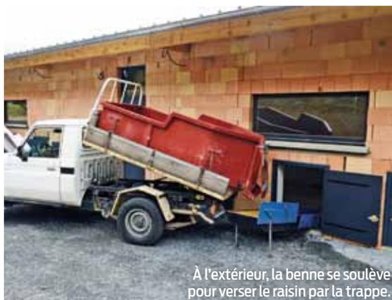
À l'extérieur, la benne se soulève pour verser le raisin par la trappe.
